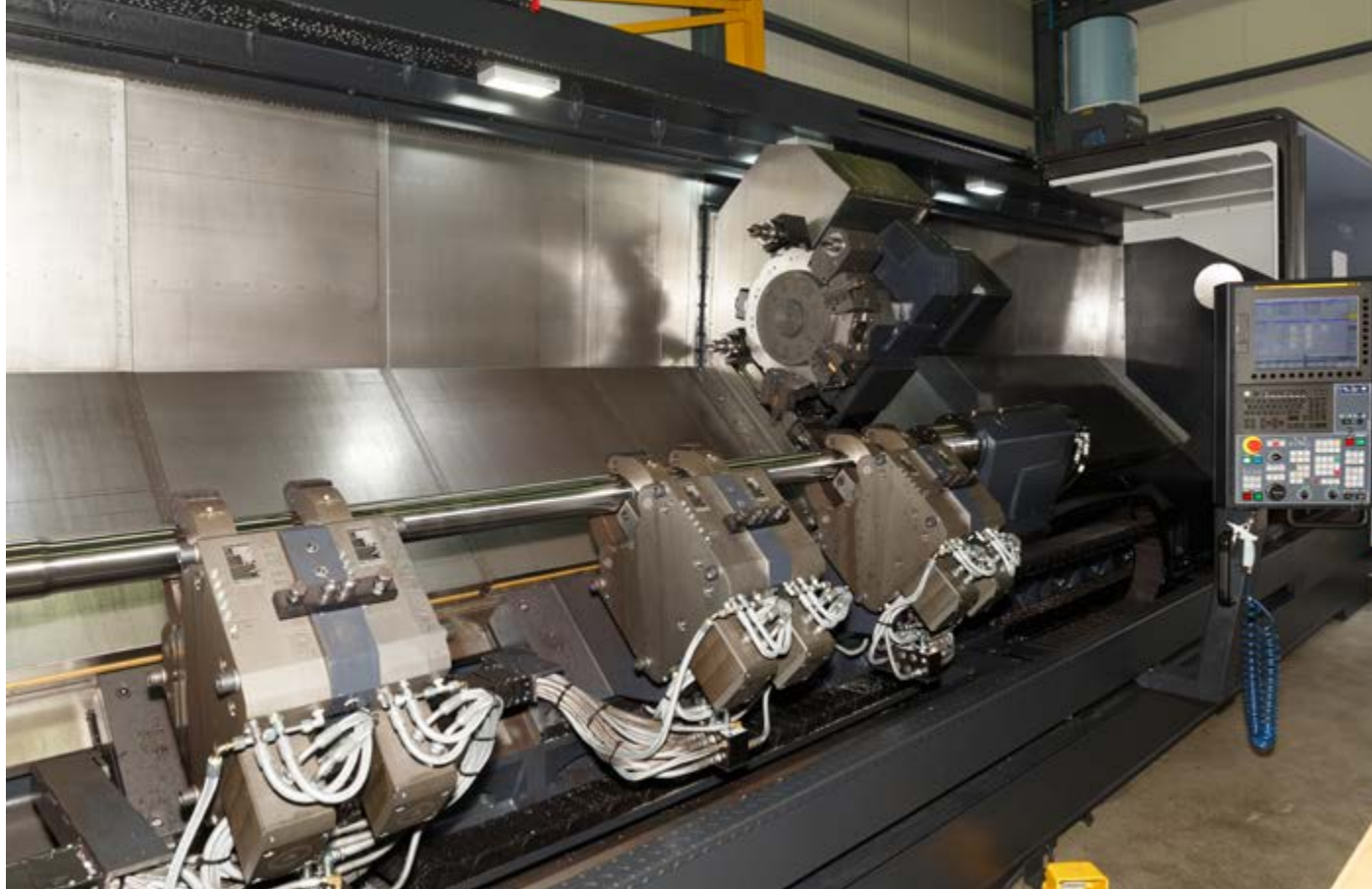
De zes brillen ondersteunen lange assen waardoor trillingen worden voorkomen. Hetraco wil in de toekomst de Puma 700 XLY verder uitbreiden met een systeem waarmee werkstukken op de machine hydrostatisch nagerold kunnen worden.
