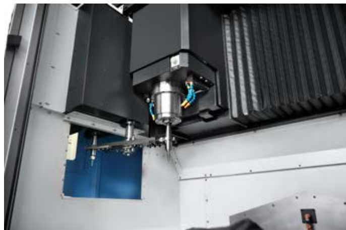
Een gereedschapswissel neemt bij de Doosan BVM 5700 slechts 1,3 seconden in beslag.
