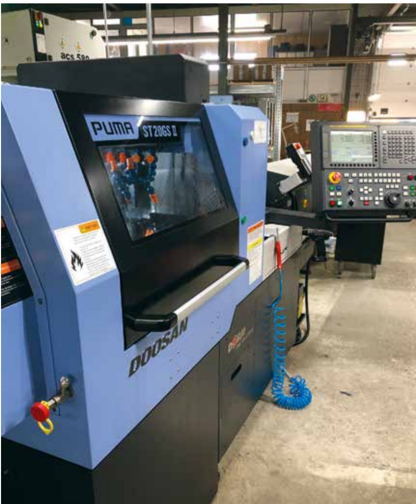
In de vestiging in Huissen is een PUMA ST20GS II geplaatst. Dit is een stabiele langdraaimachine met een hoge precisie.
