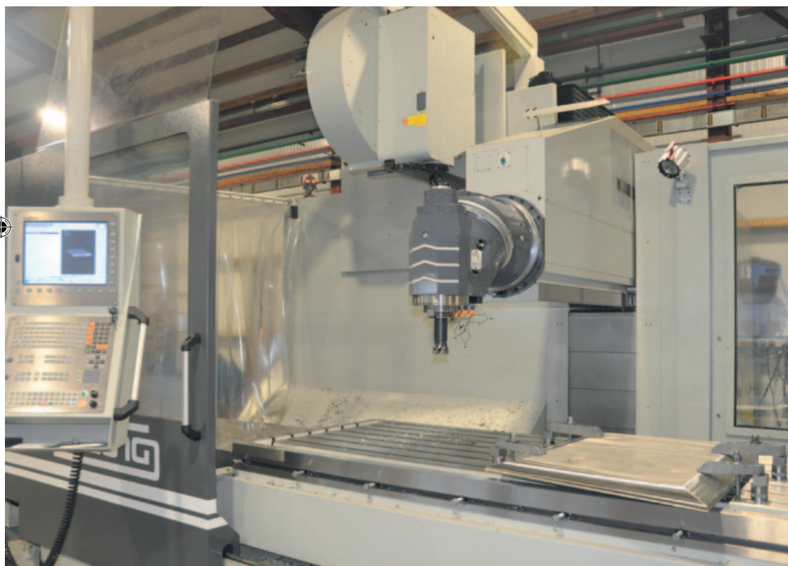
De Kiheung KNC U1200N heeft een bereik van 2600 mm x 1200 mm x 1600 mm met volledig gestuurde A4-kop.
